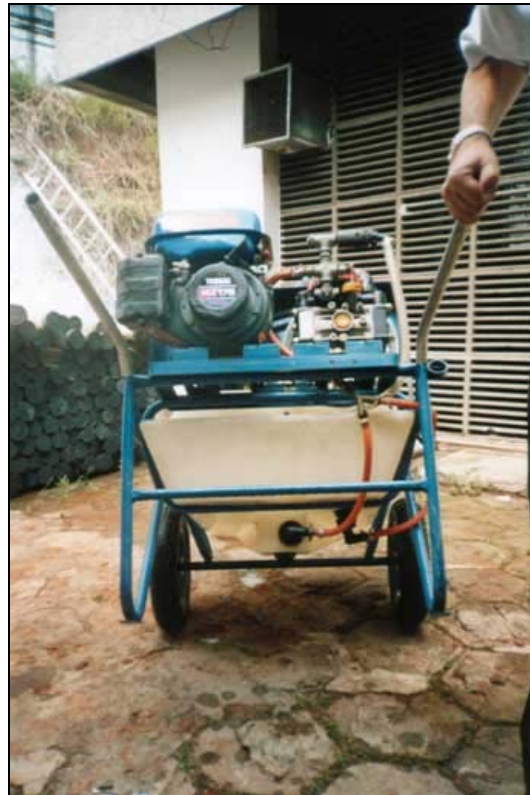
Detalhe mostrando o motor de 4 tempos e a bomba hidráulica de membrana
